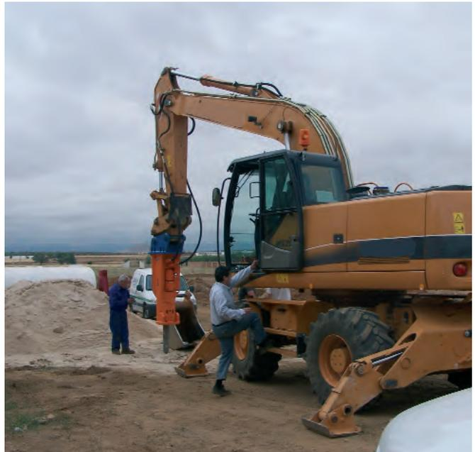
Este equipo se utiliza para demoler determinados elementos constructivos y fragmentar elementos demolidos.
