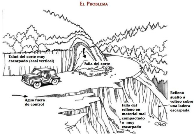
Figura 3 - Fallas en talud de corte y relleno
