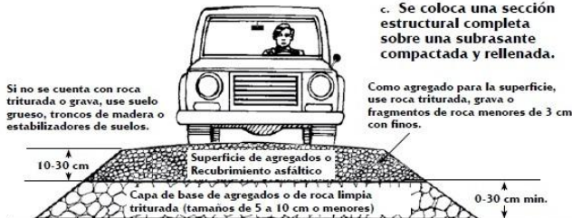
Figura 32: Opciones utilizando agregados para evitar ahuellamiento o roderas.
