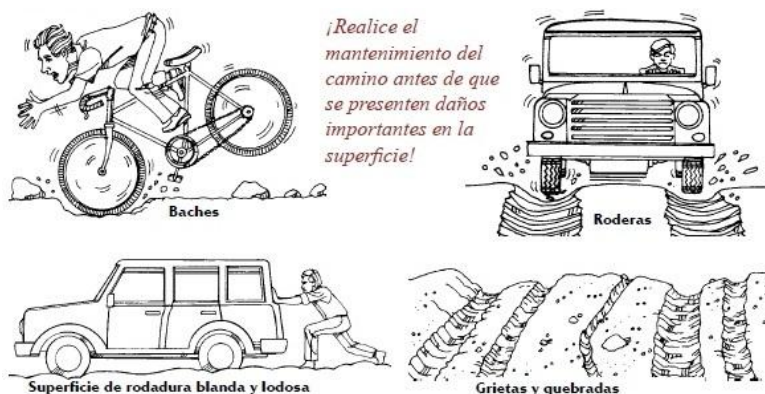
Figura 5: Evidencias de la necesidad del mantenimiento en caminos
