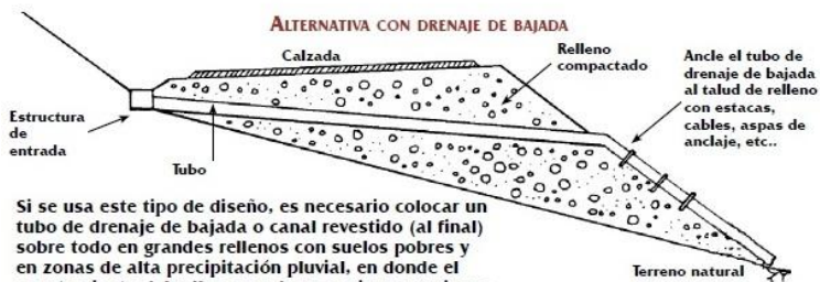
Figura 14: Opciones para la instalación de un dren transversal de alcantarilla en un relleno.
