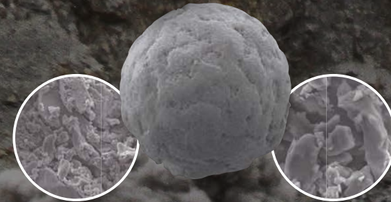
Microscopía electrónica de cristalización de Prillex® LR y gránulo completo.
