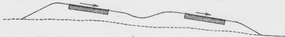
C) CANTERO CENTRAL EN CURVAS HORIZONTALES CON DRENAJE LONGITUDINAL. CALZADAS CON PERFIL LONGITUDINAL INDEPENDIENTE.
