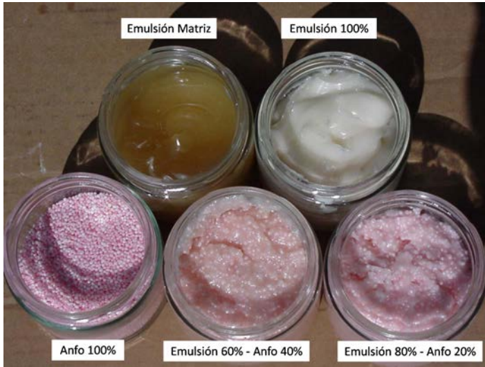
Figura 62: Diferentes tipos de emulsión en función de la proporción Emulsión/Anfo
