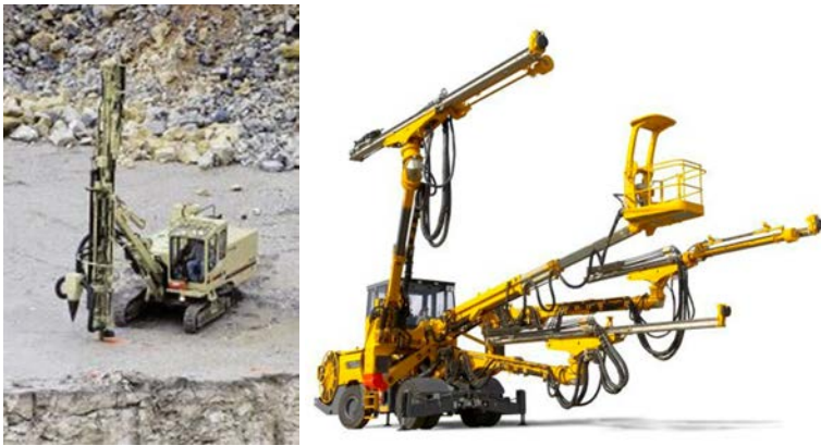
Figura 12: Carro perforador sobre orugas (izqda.) y jumbo hidráulico (drcha.)
