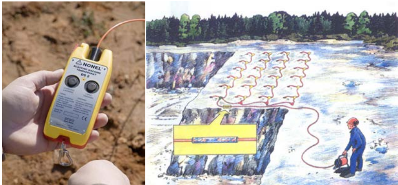
Figura 78: Iniciador “de chispa” de detonadores no eléctricos (Fuente: Dyno Nobel)
